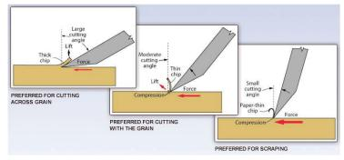
Fig. 1.6.14.1: Cutting Angle
