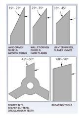
Fig. 1.6.15.1: Clearance angle
