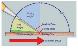
Fig. 1.6.12.1: Geometry Cutting Edge
