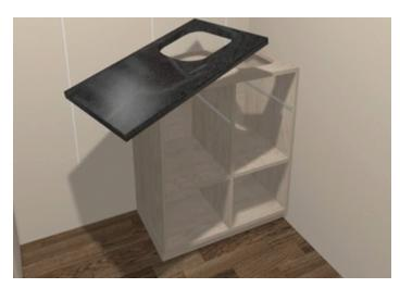
Fig. 1.4.44: Attach counter top
