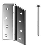
Fig. 1.4.57: Butt Hinge
